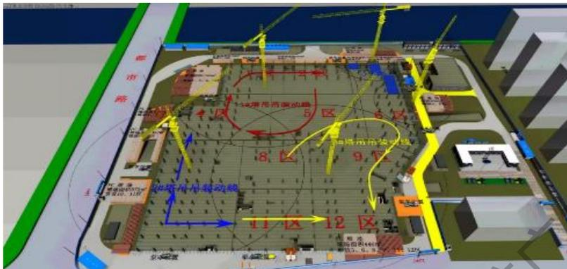
图 2-43 塔吊整体吊装动线
